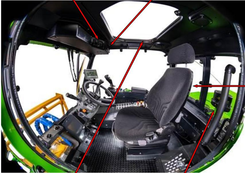
**Удобное сидение оператора GRAMMER (Германия)** с пневматической подвеской, подлокотниками, регулируемой поясничной поддержкой, подогревом и датчиком присутствия оператора входящим в комплексную систему безопасности машины
