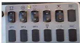
Нажмите выключатель 55d, чтобы включить компрессор сжатого воздуха; при отсутствии давления в системе компрессор автоматически отключается.
