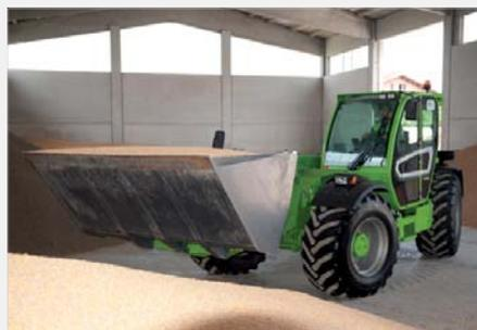
Гидропневматическая подвеска BSS стрелы (опция), активируемая оператором, отключается автоматически при скорости менее 3 км/ч для гарантии максимальной точности при позиционировании грузов.
