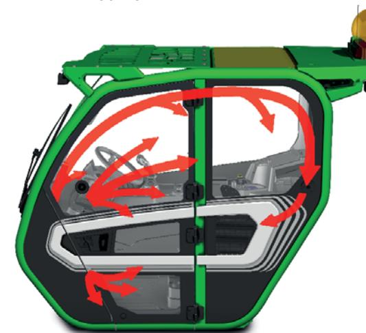
Поток воздуха равномерно распределяется внутри салона и достигает оптимальным образом всех зон.
