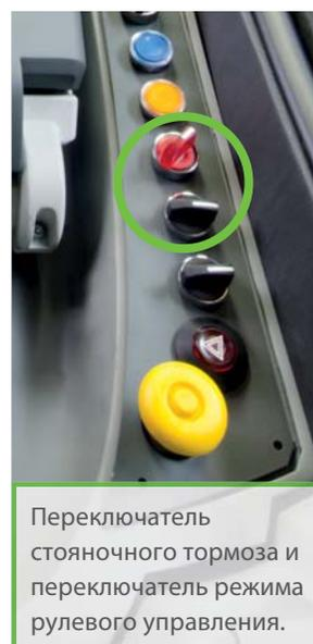
Переключатель стояночного тормоза и переключатель режима рулевого управления.
