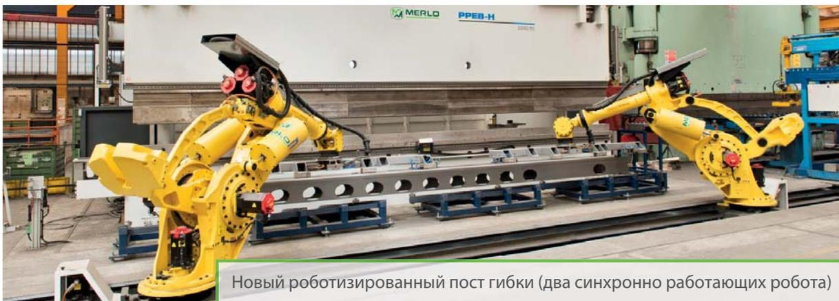
Новый роботизированный пост гибки (два синхронно работающих робота)
