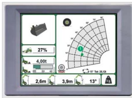
Системой MCDC проверяются в реальном времени условия продольной стабильности, и оператору предоставляются указания относительно процента использования условия максимальной стабильности. Максимальная безопасность.
