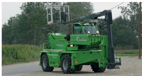
При транспортировке система Space может быть закреплена непосредственно на машине.
