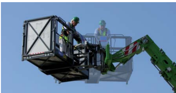
Поворотная платформа с гидроприводом позволяет приспособить ее положение к рабочей зоне.
