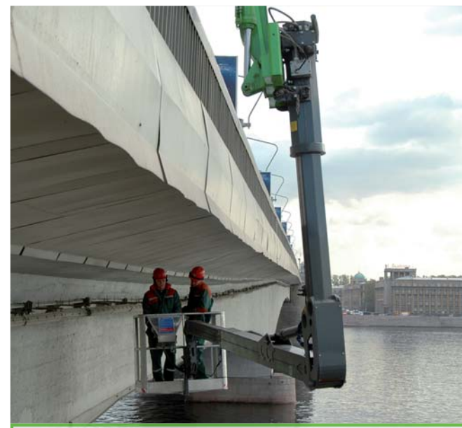
Система Space позволяет работать на отрицательной высоте – до 8 метров относительно уровня поверхности.
