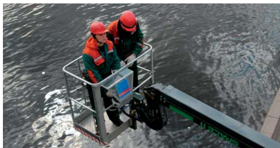
Вне зависимости от типа используемой платформы, оператор, непосредственно контролирует ее движения.
