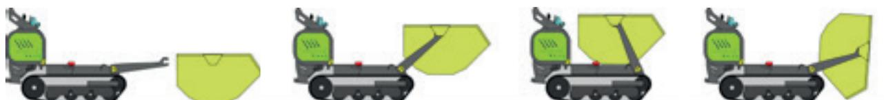
Технологической основой многофункциональных машин Cingo является запатентованное устройство быстрого присоединения орудий, состоящее из двух смонтированных на тележке прочных механических рычагов. С ним совместима большая часть орудий многофункциональной системы.
