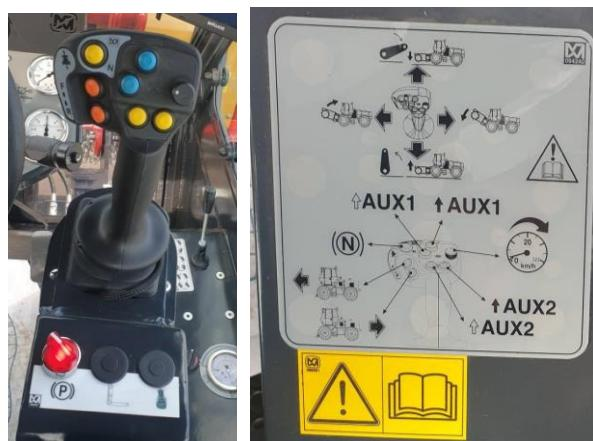
Многофункциональный джойстик оборудован не только кнопками управления мульчерной навеской, но и сменой направления движения машины (реверсом), что облегчает процесс управления, снижает усталость и позволяет оператору сосредоточится на выполнении поставленной задачи.
