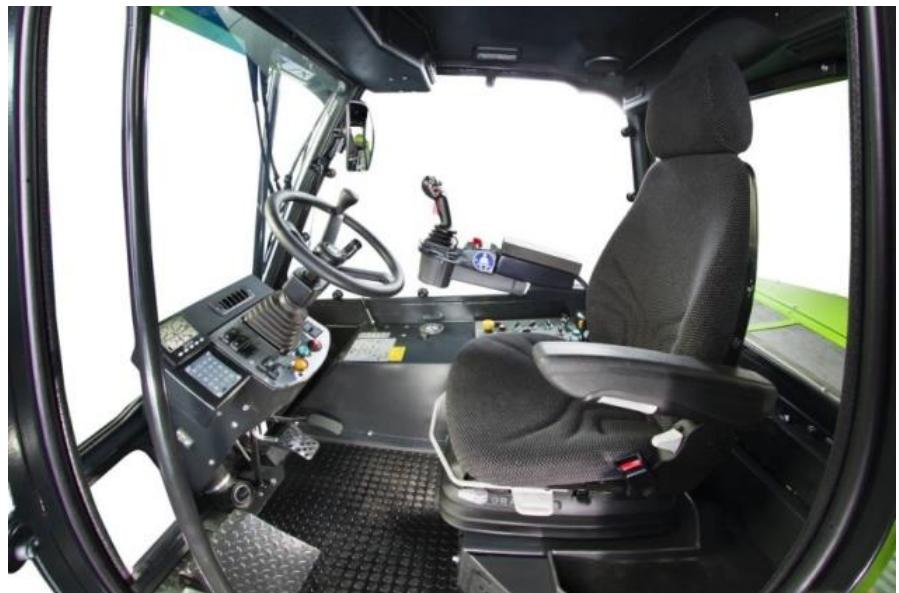
Управление движением машины и рабочим оборудованием производится с помощью многофункционального электронного джойстика, установленного на правом подлокотнике сидения оператора.
