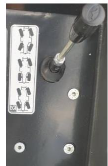
Четыре управляемых колеса с гидроусилителем руля. Три режима рулевого управления, которые обеспечивают уменьшенный угол поворота, высокую манёвренность и подвижность при внедорожных работах
