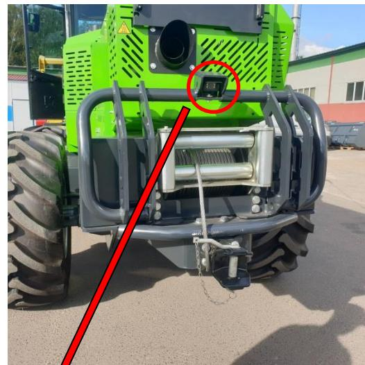
Камера заднего вида (закреплённая в верхней части защитной рамы лебёдки) + монитор в кабине оператора
