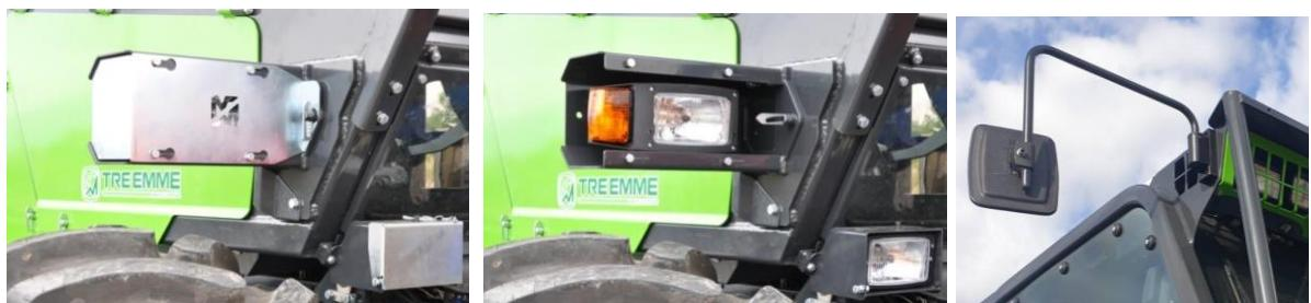
Задние габаритные дорожные осветительные приборы имеют два положения:
