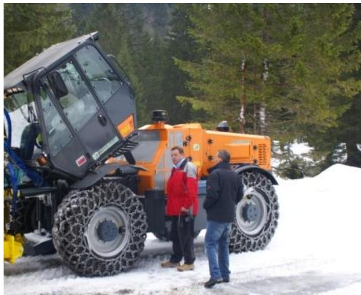
Отличительной особенностью самоходного колесного мульчера TRE EMME MM180B является то, что оператор сидит в кабине строго по ходу движения машины с постоянным визуальным контролем мульчерной навески, что дает преимущество полного контроля за процессом мульчирования.
