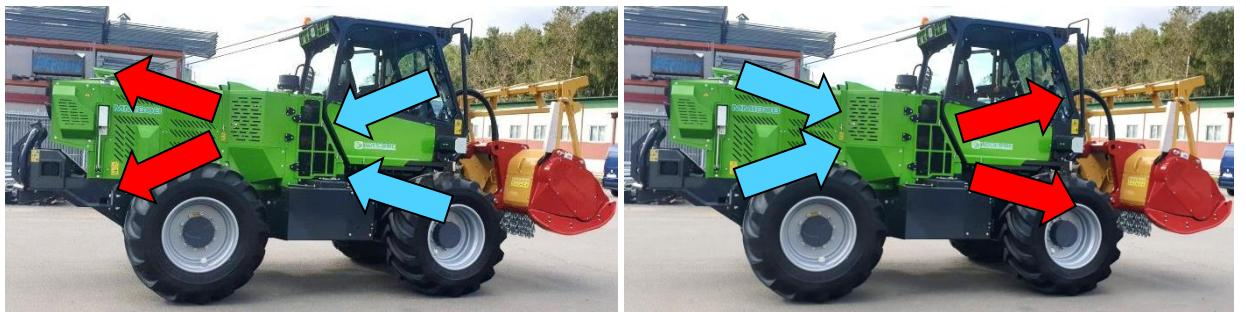
Нормальное функционирование при движении вперёд (в рабочем режиме мульчирования)
