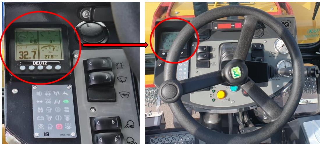
**Дисплей компьютера MERLO** с указанием кодов ошибок систем MERLO, диагностики гидравлики и работы вентиляторов системы охлаждения, оборотов двигателя и скорости передвижения машины
