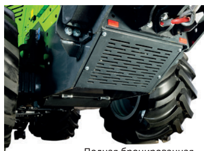
Полная бронированная защита нижней части шасси
