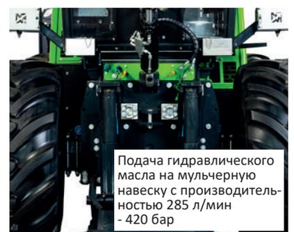
Подача гидравлического масла на мульчерную навеску с производительностью 285 л/мин - 420 бар
