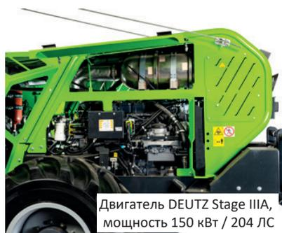
Двигатель DEUTZ Stage IIIA, мощность 150 кВт / 204 ЛС
